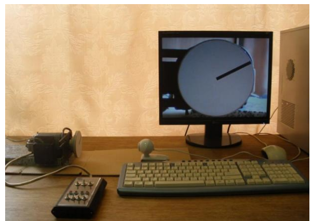
Діючий макет пристрою для вимірювання параметрів руху об'єктів
